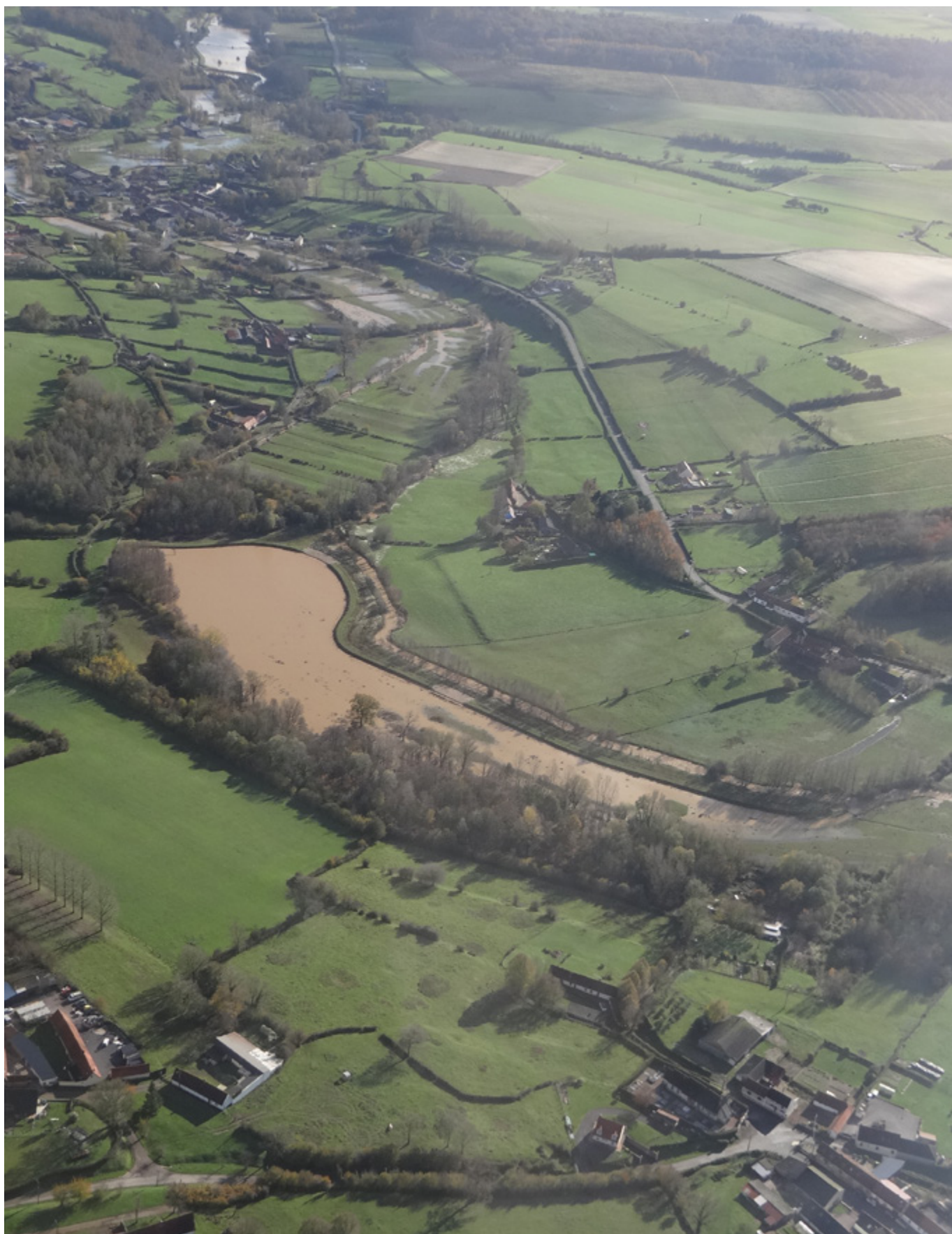
Photo 13 : Champ d'Inondation contrôlée en crue
